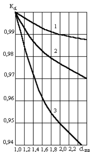
Рис.6. График определения K_a : 1, 2, 3 – соответственно все виды твердого топлива, жидкое и газообразное топливо
